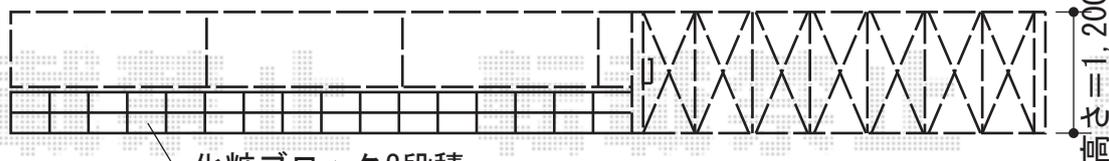
※正面ブロックに、3カ所程水抜き穴を作ります。
