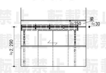
トステム パワーアルファ L型 屋根タイプ 単体 積雪対応~30cm 間口=関東間1.5間(柱芯々2,755mm 屋根幅3,080mm)
