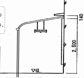
トステム ライザーテラスII R型 テラスタイプ 連棟 積雪~20cm対応 間ロ= メーター8000[4000+4000] (柱芯々7,800mm 屋根幅8,020mm)
