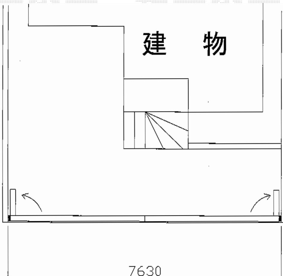
Value Select トリップゲート PB型 ノンレール 両開き76W
