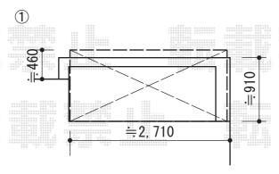
YKK AP ヴェクター R型 屋根タイプ 単体 積雪~20cm対応 間口=関東間1.5間(柱芯々2,448mm 屋根幅2,760mm) 出幅=4尺(1,170mm) 色:プラチナステン屋根材:ポリカーボネート(スモークブラウン)
