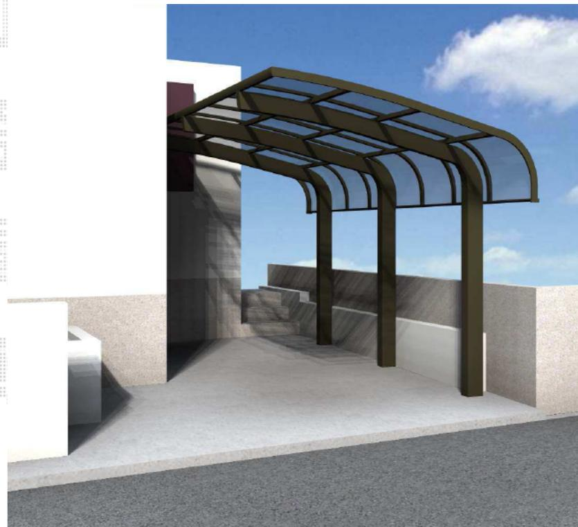
既存カーポート(スチール製) (RC? 立ち上がり部GL+470) 解体・撤去処分
